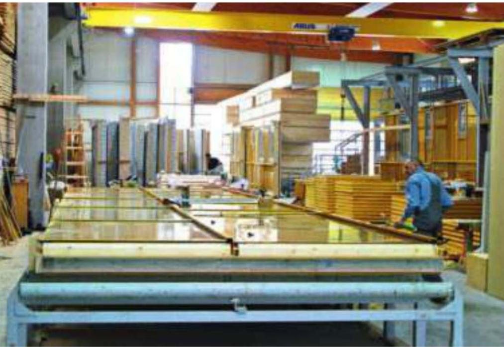
Fassadenlösung ab Werk: GAP liefert unterschiedliche Varianten mit integrierter Gebäudetechnik
